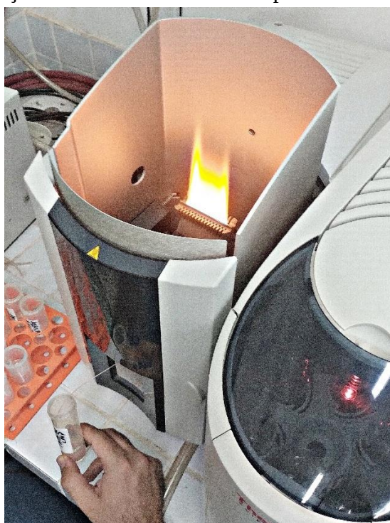
Figura 11 — Determinação analítica de metais em espectrofotômetro de absorção atômica
