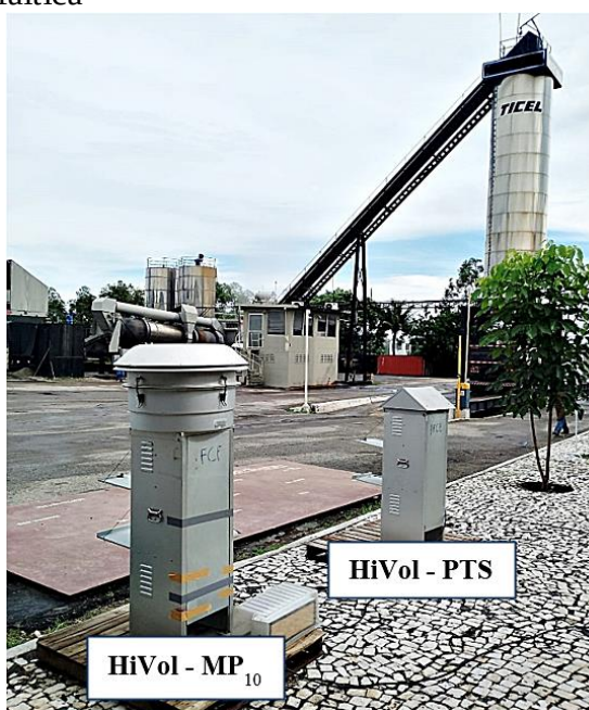
Figura 7 — Amostradores HiVol para determinação de particulados (PTS e \text{MP}_{10} ) no pátio industrial de usinagem asfáltica
