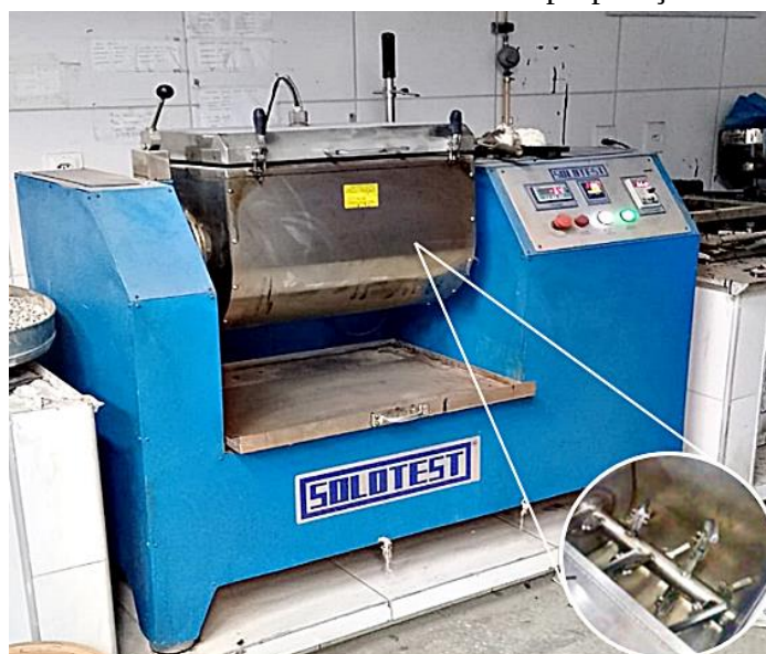
Figura 8 — Misturador batelada usado nos ensaios de preparação de misturas asfálticas
