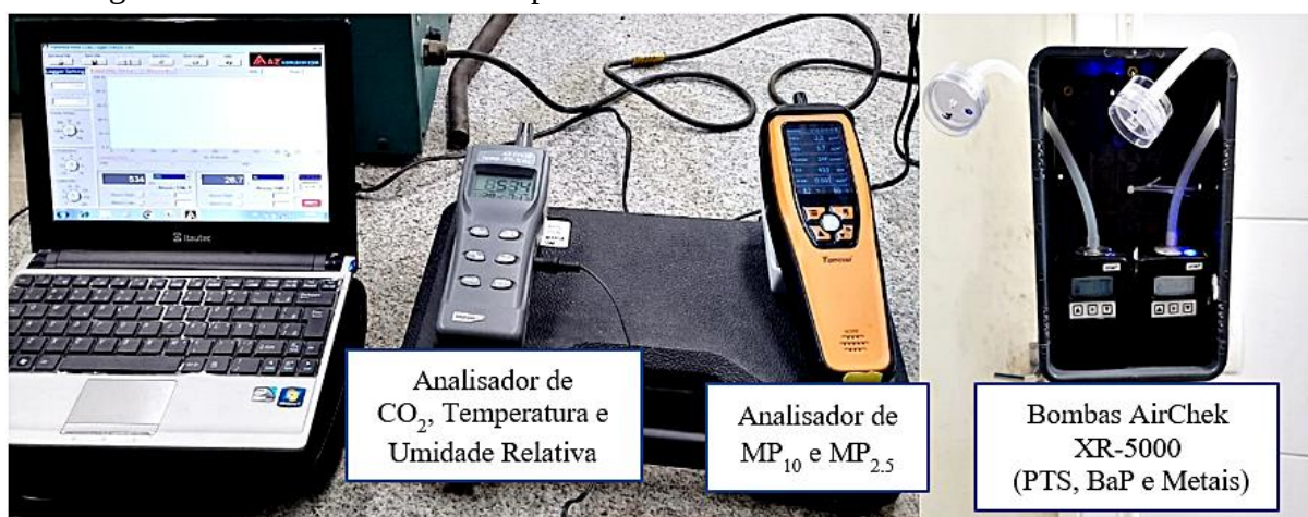
Figura 10 — Analisadores multiparâmetros e sistema de bombas AirChek XR-5000
