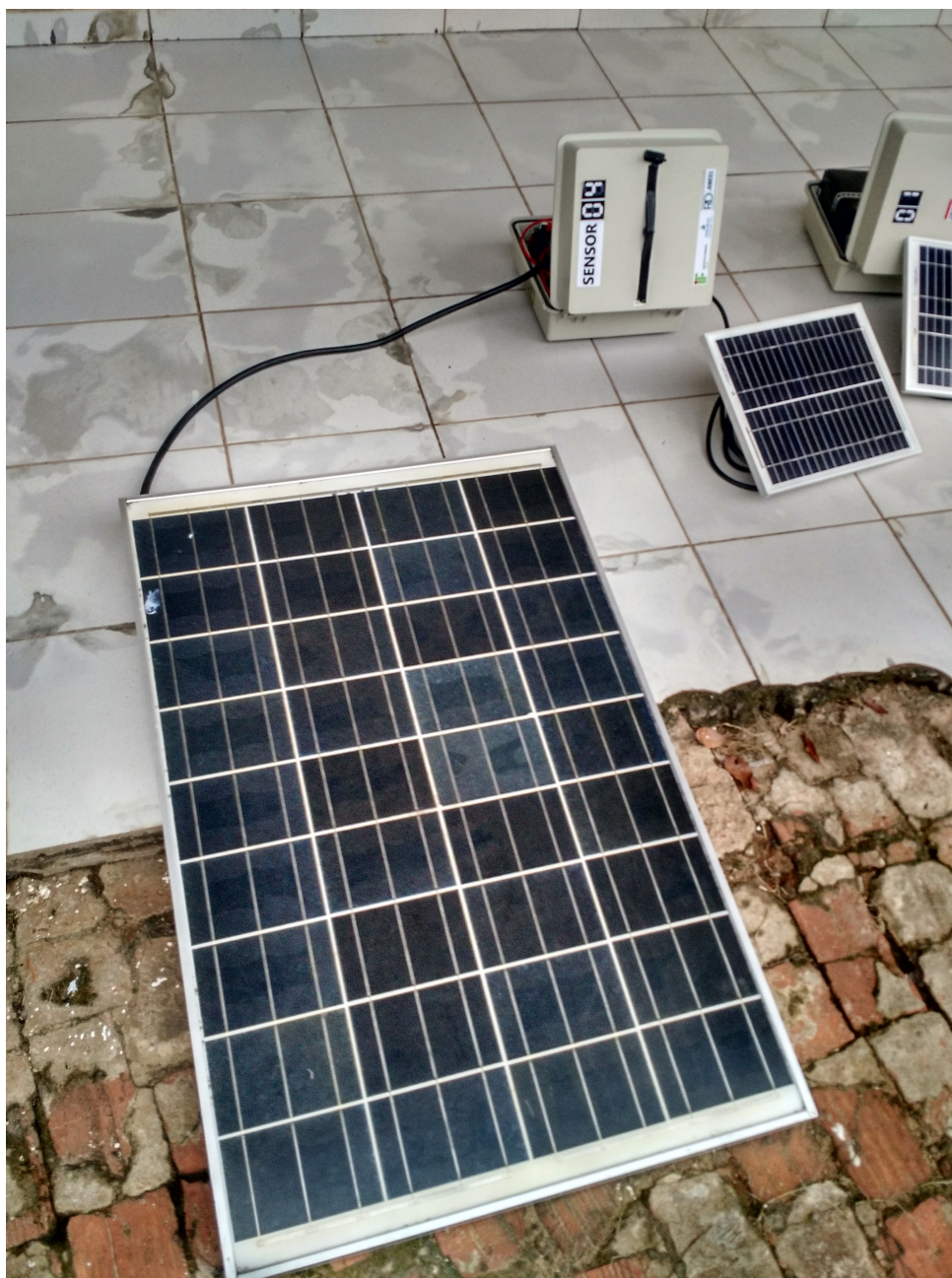
Figura B.3: Sensor gateway em processo de carga com o auxílio de um painel solar com maior capacidade.
