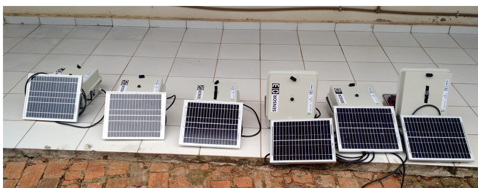
Figura B.2: Sensores enfileirados para carregamento da bateria utilizando painéis solares.
