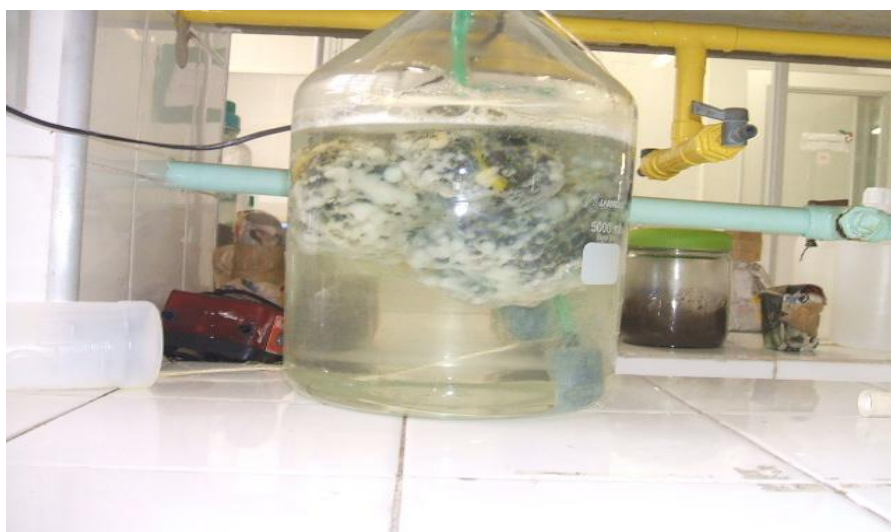
Figura 10 - Ilustração do reator operado em regime de batelada sequencial (RBS).
