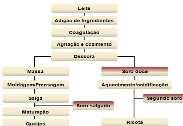
Figura 7 - Fluxograma representando a produção de queijos e a geração dos soros usados na etapa preliminar.
