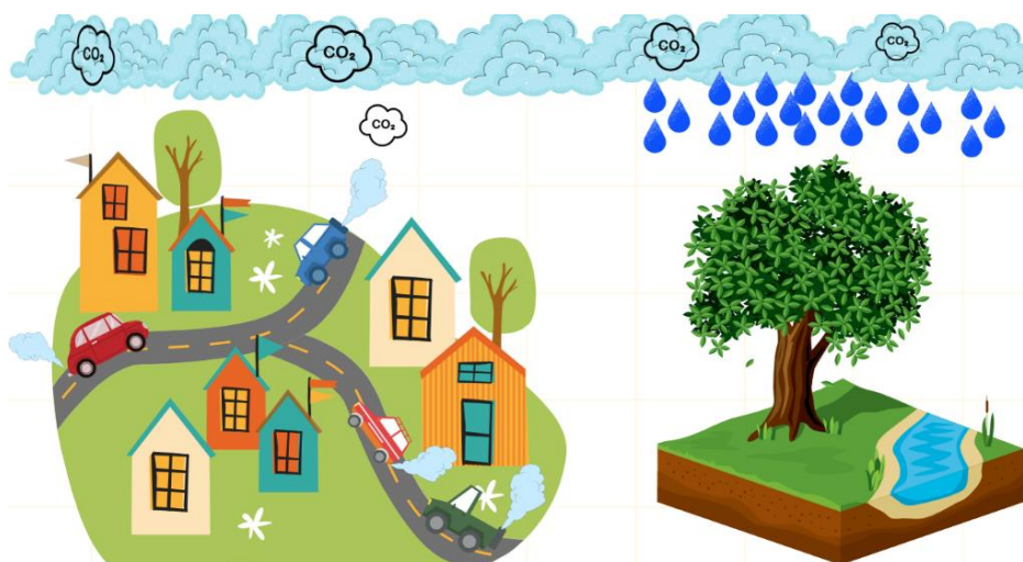
Figura 10. Esquema de ocorrência das chuvas ácidas, causadas pela queima de combustíveis fósseis.
