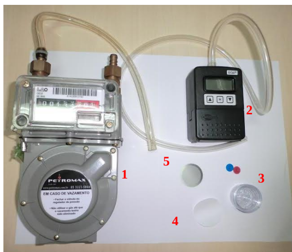
Figura 9 – Imagem dos aparatos de coleta dos materiais particulados: gasômetro (1), bomba (2), cassete (3), filtro (4) e PAD em aço (5).
