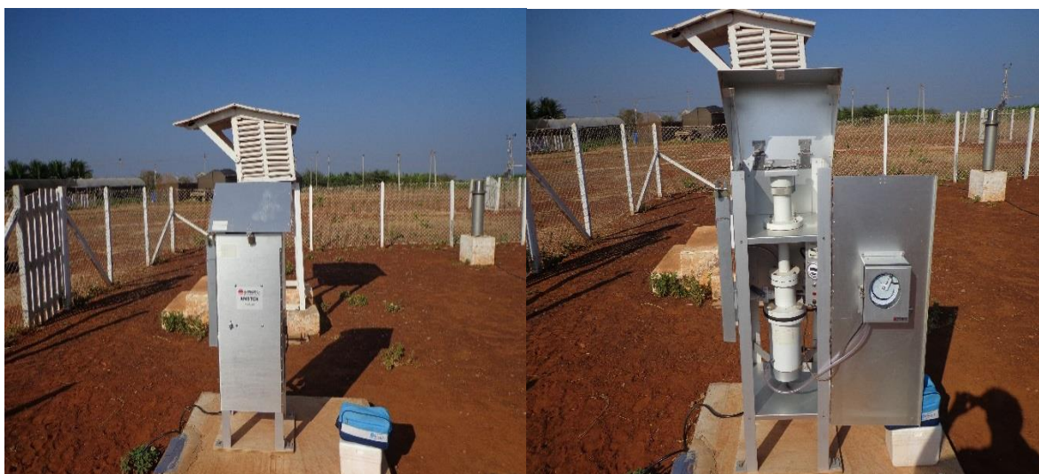
Figura 7 – Imagem do amostrador Amotox modelo Energética Ltda usado no monitoramento atmosférico do herbicida glifosato na área de estudo da UEPE de Limoeiro do Norte.
