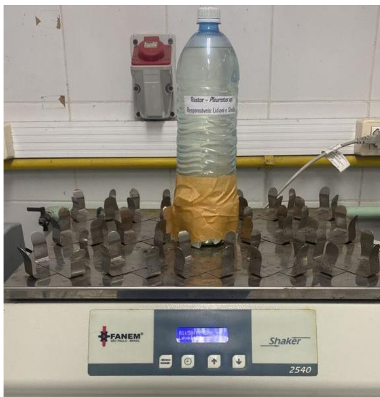
Figura 7 — Reator montado para crescimento da biomassa
