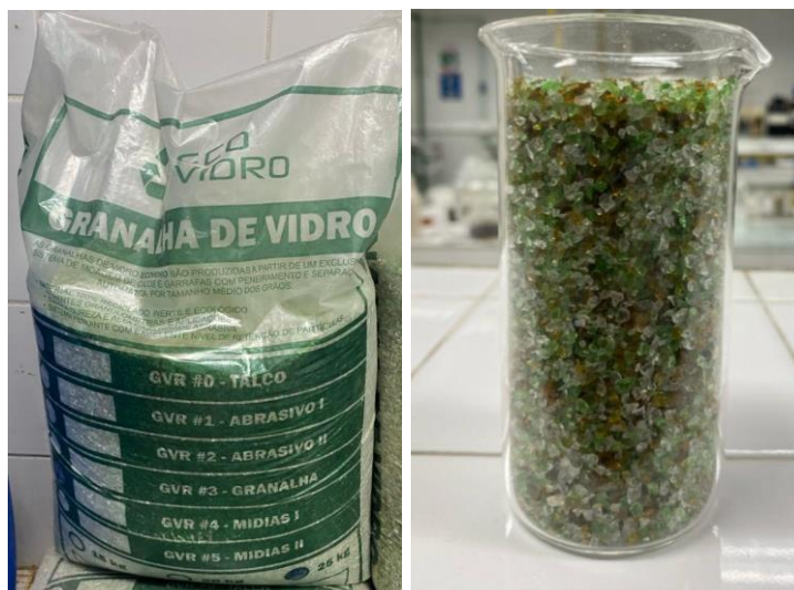
Figura 5 — Granalhas de vidro usadas como meio suporte nos reatores com efluente L1 e L2
