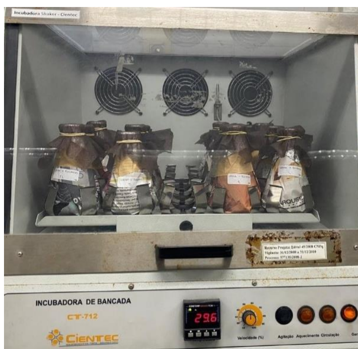
Figura 8 — Reatores em agitação na incubadora de bancada
