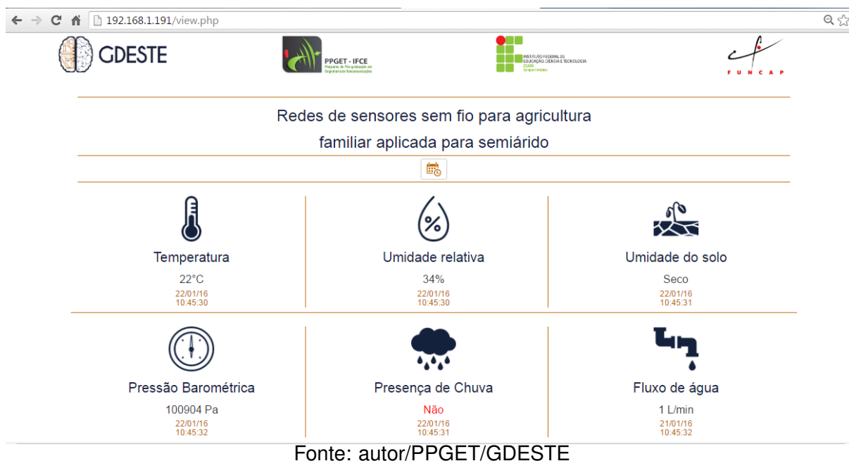
Figura 33 – Interface Gráfica do Usuário com exibição dos parâmetros monitorados pela RSSF.
