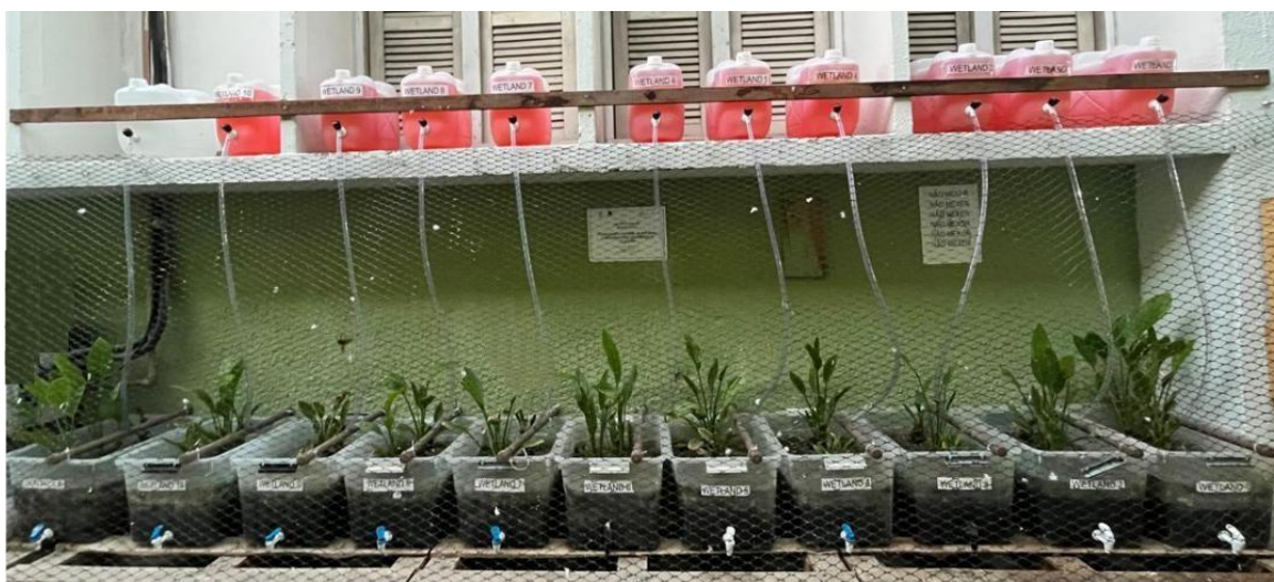
Figura 9 — Imagem dos wetland construído em operação segundo o planejamento fatorial
