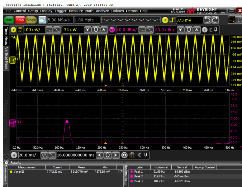
Figura 32 – Sinal visto no osciloscópio ao usar o circuito eletrônico contendo o filtro passa faixa, cuja resultante no domínio da frequência é de 120 Hz.
