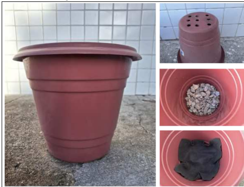
Figura 4 — Vaso de polietileno com capacidade de 6 L utilizado no estudo e detalhes do sistema de drenagem.
