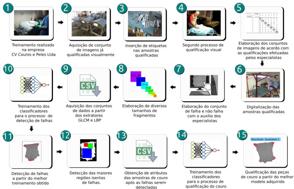
Figura 5 – Procedimentos metodológicos realizados para a elaboração do sistema
