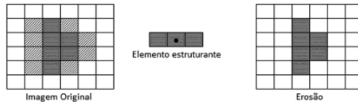
Figura 49 – Exemplo da aplicação da erosão.
