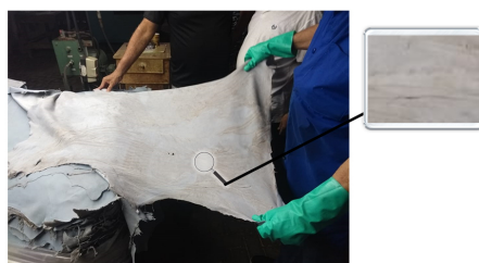
Figura 7 – Peça de couro no lado carnal. Em destaque a falha corte leve de faca.
