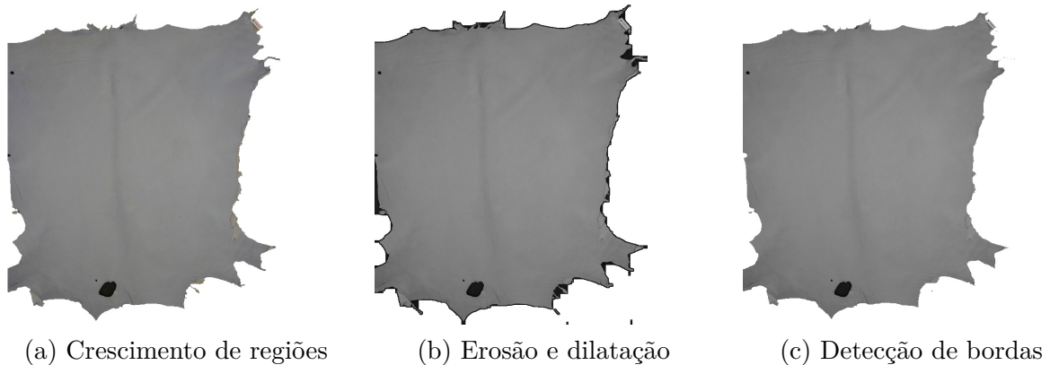
Figura 30 – Técnicas aplicadas para remoção do plano de fundo.
