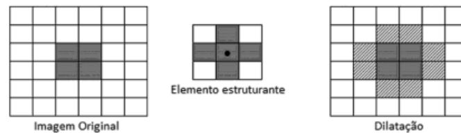
Figura 51 – Exemplo da aplicação da dilatação.
