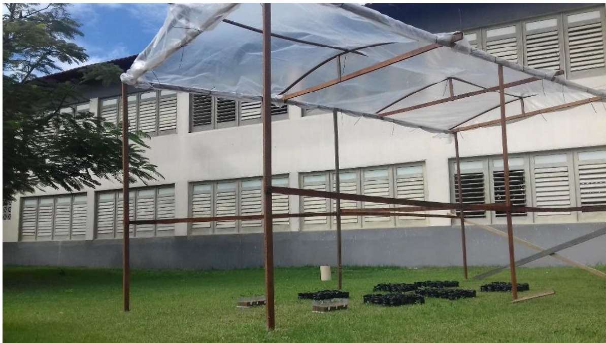
Figura 37 – Estrutura de madeira coberta com filme plástico para proteção contra chuva utilizada para a realização do experimento.
