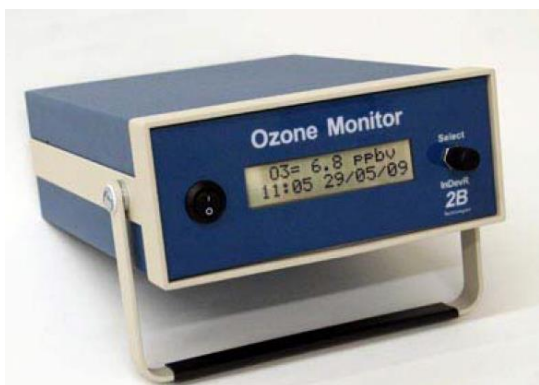
Figura 6 – Monitor de ozônio utilizado na pesquisa para as determinações do O_3 troposférico.
