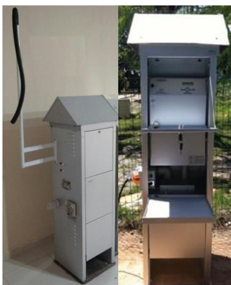
Figura 4 - Imagem do amostrador Hivol com inlet para PTS utilizado na pesquisa.
