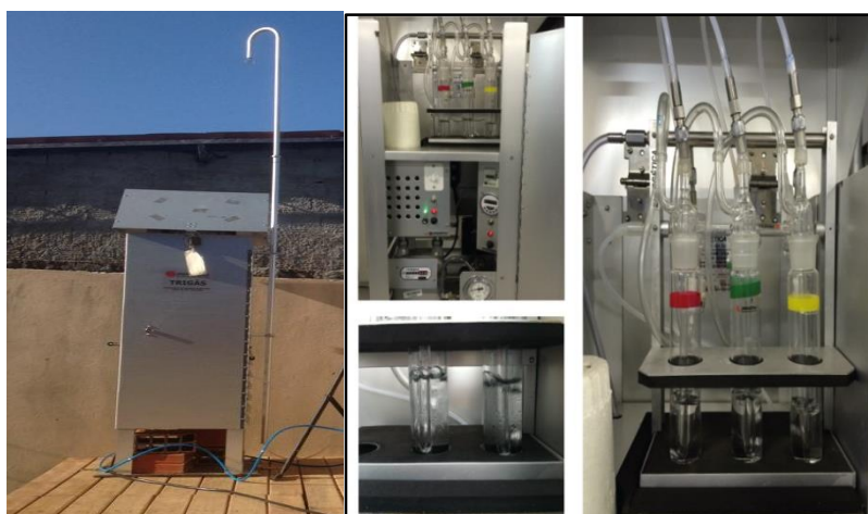
Figura 5 - Imagens do equipamento Trigás com detalhamento dos frascos amostradores.
