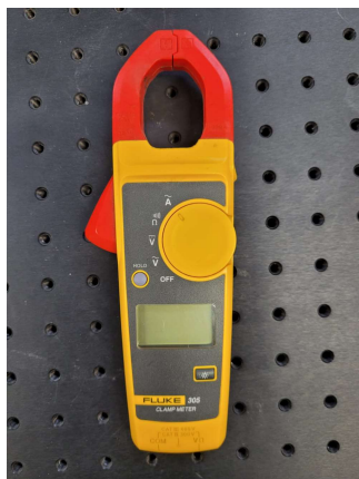
Figura 28 – Alicate amperímetro para medições até 600 A (à esquerda). Teslameter para medição de campos magnéticos direto ou alternado (à direita).
