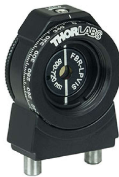
Figura 20 – Módulo de polarização linear no modelo FiberBench, com rotação em 360° para sistema de fibra óptica, 500 - 720 nm.
