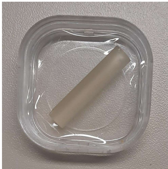
Figura 22 – Cristal com propriedades magneto-ópticas do tipo MR3-2 Glass.
