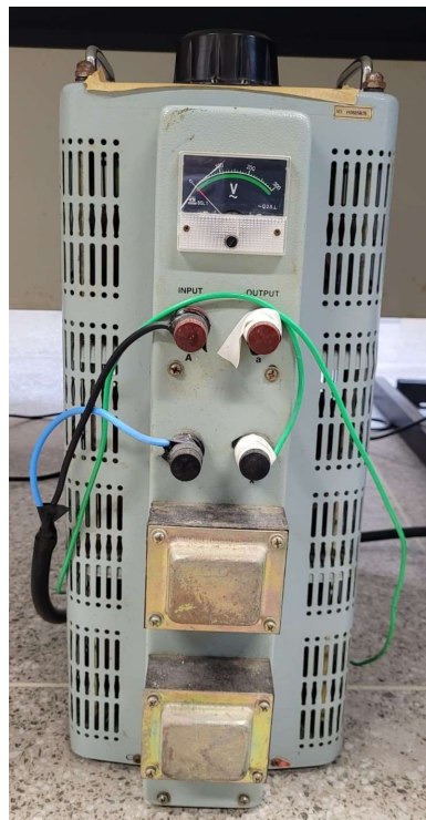
Figura 26 – Regulador de tensão Variac, 0 a 220 V.
