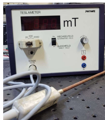
Figura 28 – Alicate amperímetro para medições até 600 A (à esquerda). Teslameter para medição de campos magnéticos direto ou alternado (à direita).
