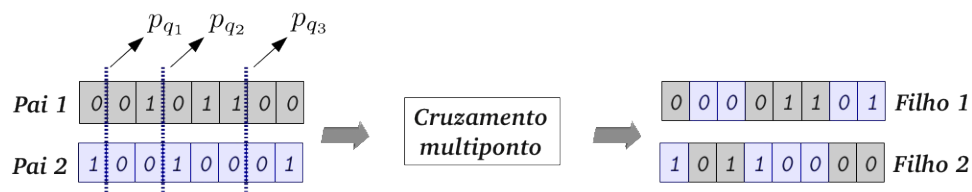
Figura 11: Processo de reprodução através do operador de cruzamento multiponto.
