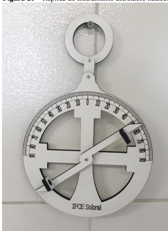
Figura 20 – Réplica do instrumento astrolábio náutico
