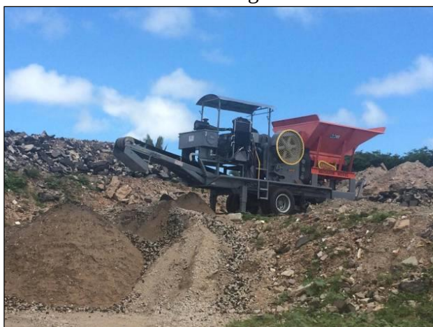
(a) Britador utilizado na usina de tratamento Fonte: Autora (2020)
