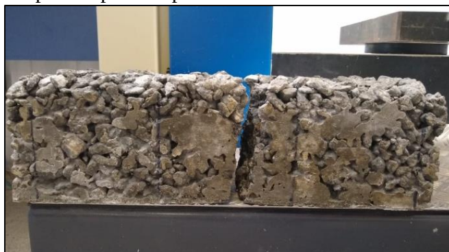
Figura 16 – Corpo de prova após rompimento no ensaio de resistência à tração na flexão
