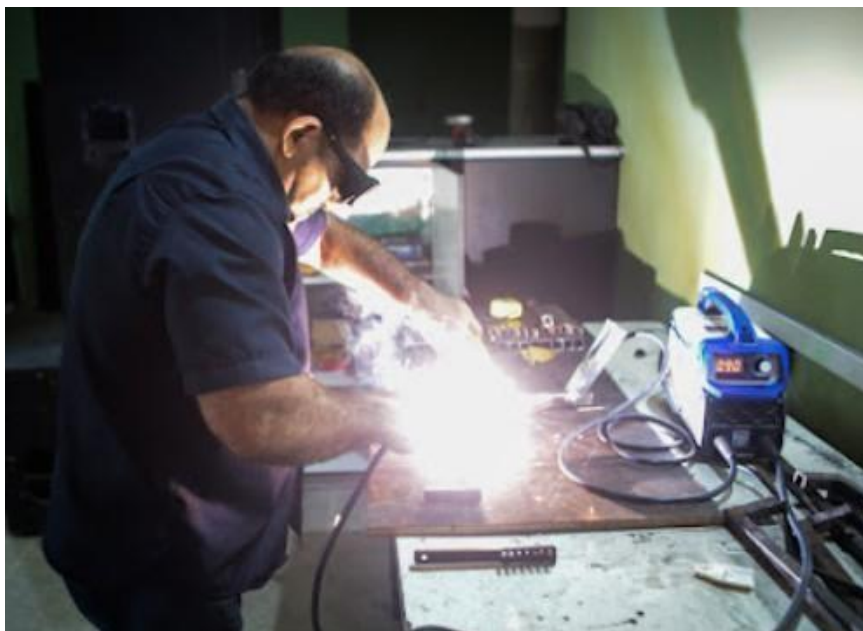
Figura 16 – Autor realizando a soldagem do material metalon.
